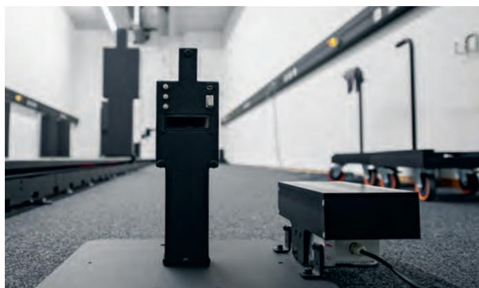
Prüfstand für Bewegungs- und Präsenzmelder für die Beleuchtungstechnik.
